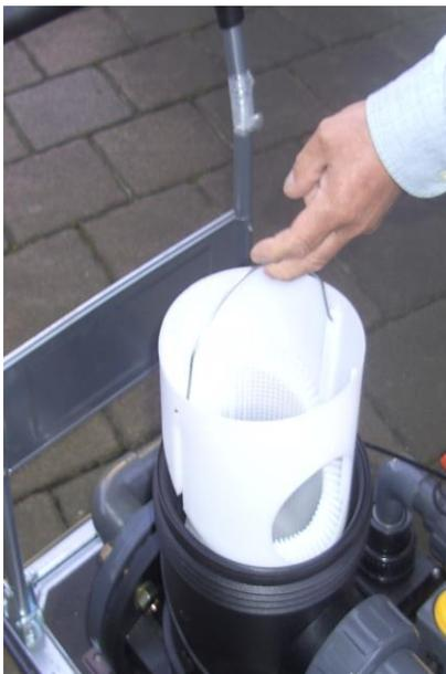
*Abbildung 5: Entnahme des Filterkorbs*
