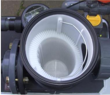
Abbildung 2: Geöffnetes Filtergehäuse mit Wasser füllen
