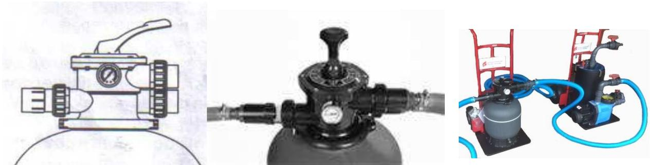
Auf einer Seite (im Bild links) ist ein einzelner Anschluss angebracht. Hier wird die Verschraubung mit dem Schauglas befestigt. Dieser Anschluss dient ausschließlich dem Rückspülen des Filters. Der daran befestigte Schlauch leitet das Schmutzwasser ab. Auf der anderen Seite gibt es zwei Anschlüsse.
